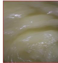
Das von der OKFT Kft. entwickelte Hydro-Gel ist ein Gel auf Wasserbasis, das keinerlei schädliche Stoffe enthält, und völlig umweltfreundlich ist. Dank diesen Eigenschaften kann es mit höchster Sicherheit bei der Reinigung auch von Trinkwasserleitungen angewandt werden. Das Gel geht – auf die Wirkung des Wasserdrucks – als ein Stöpsel in der Rohrleitung voran, und nimmt ihre Form perfekt auf. Es kann die Verschmutzungen aus allen Ecken in sich sammeln.
